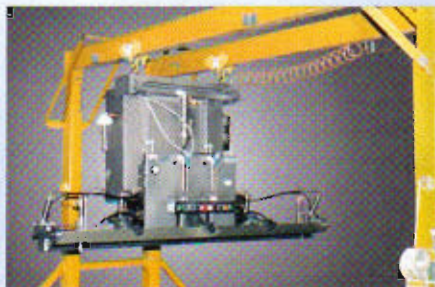
Die A-200 Overhead lässt sich an ein Portal oder einen Galgen montieren
